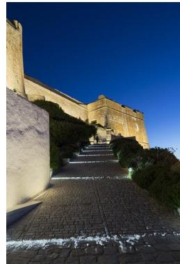
23 mini projecteurs 1750A-Bourgogne créent l'illusion d'une échelle de lumière tout en sécurisant et rythmant la montée Saint-Roch. Chaque projecteur est installé dans une petite borne en aluminium, positionnée sur le côté intérieur de la montée, gravée et usinée sur mesure avec les armoiries de la ville
