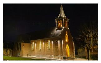
Des projecteurs **Luminy2 (4020)** sont installés sur le haut des arrêtes de la toiture, des arrêtes extérieures du clocher et de la façade principale afin de mettre en valeur le bâtiment. Le faisceau frise le pilastre et dessine une ligne.
