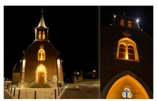
Un projecteur **Arches (5633)** est installé sur le rebord de la fenêtre avec un faisceau directionnel qui épouse l'intérieur de l'encadrement
