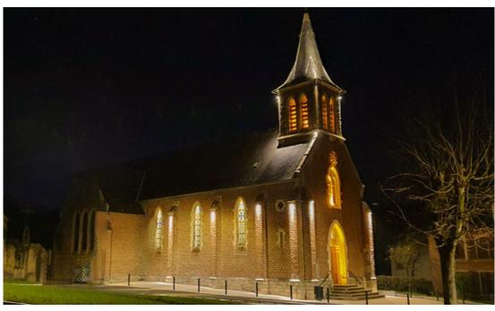
Plusieurs types de luminaires LEC ont été installés pour éclairer et sublimer l'église de Saint-Maurice; des Luminy (4020) pour un éclairage de haut en bas afin de souligner la façade et les arrêtes du clocher, des Clem (5651) pour l'intérieur du clocher, des Arches (5633) pour sublimer les vitraux et des Albi (5712) pour mettre en valeur le porche.
