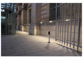
7 linéaires 5640-School Light en blanc neutre à optique L2 sont intégrés dans les mains courantes 5682-School d'un diamètre de 48 mm.
