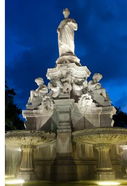
Statue : 5 Strahler des Typs 4021T-Luminy 2, 230V, integriert, mit 3 LEDs 3W, warmweiß, 36° Kollimator
