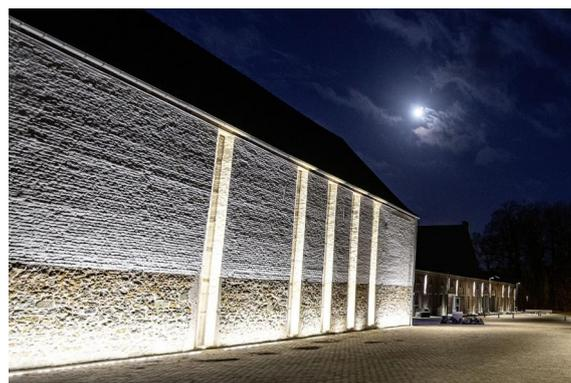
19 mètres de barreau Brunei (5620), équipés de LED de type Z et d'optique 45° éclaire d'un blanc neutre la grande facade du bâtiment. Les 5 alcoves toutes en hauteur sont soulignées par des projecteurs Allevard (5716)
