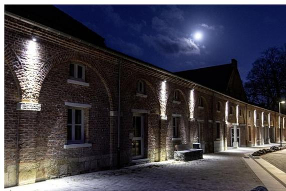
12 projecteurs Luminy2 (4020) en blanc neutre avec des optiques 20° sont implantés en hauteur pour mettre en valeur les piliers de la façade.
