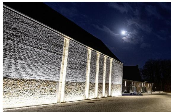
19 mètres de barreau Brunei (5620), équipés de LED de type Z et d'optique 45° éclairent un blanc neutre la grande façade du bâtiment. Les 5 alcôves toutes en hauteur sont soulignées par des projecteurs Allevard (5716)
