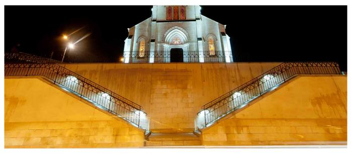
Éclairage de l'escalier devant l'église : 2 projecteurs muraux <u>4240-Havre</u> en 4 superwatts 3W blanc froid, et 6 barreaux de 300mm de long <u>5630-Belval</u> en 6 superwatts 0.8W blanc froid, Elliptique 1.
