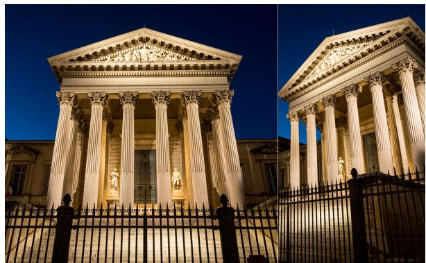
2 projecteurs 4060-Luminy 6 en blanc neutre à optique 6° sont fixés derrière les balustrades, au niveau de la toiture des ailes du bâtiment (1 de chaque côté), et éclairent le fronton (en tir croisé) et 2 autres en 10° éclairent l'emmarchement (en tir croisé).
