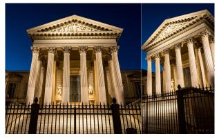
2 projecteurs 4060-Luminy 6 en blanc neutre à optique 6° sont fixés derrière les balustrades, au niveau de la toiture des ailes du bâtiment (1 de chaque côté), et éclairent le fronton (en tir croisé) et 2 autres en 10° éclairent l'emmarchement (en tir croisé).
