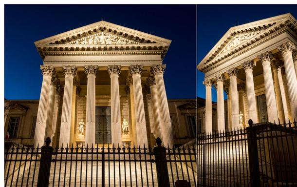
2 projecteurs 4060-Luminy 6 en blanc neutre à optique 6° sont fixés derrière les balustrades, au niveau de la toiture des ailes du bâtiment (1 de chaque côté), et éclairent le fronton (en tir croisé) et 2 autres en 10° éclairent l'embranchement (en tir croisé).
