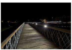
Les 45 projecteurs linéaires sont en 6 superwatts 0.8W blanc neutre, 24 VDC, Elliptique 2 - D20 orientation Est.
