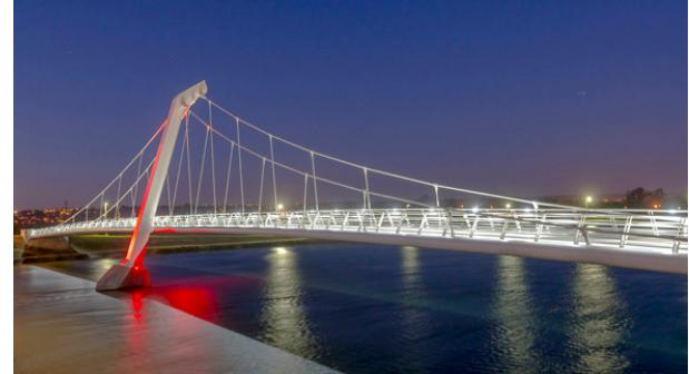
Pylône : 4040 Luminy 4, projecteur orientable à LED, ouverture 10°, 3x4 superwatts 3W : rouge/vert/bleu
