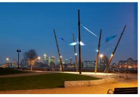
5 x 4040-CW12-20 LUMINY 4, ouverture 20°, 12 Superwatts 3W bland froid et 3 x 4040-CE12-36 LUMINY 4, ouverture 36°, 12 Superwatts 3W blanc chaud.
