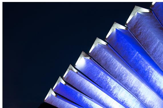
30 projecteurs 4020-Luminy 2 en blanc froid, optique 20° sont installés sur les pointes (en V) de la plateforme, côté français.
