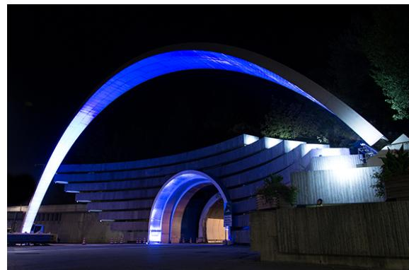
14 projecteurs 4040-Luminy 4 en blanc froid, optique 10° permettent un éclairage latéral des blocs de béton situés sur les côtés de l'entrée du tunnel, plateforme italienne.
