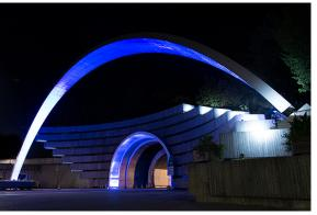
14 projecteurs 4040-Luminy 4 en blanc froid, optique  $10^\circ$  permettent un éclairage latéral des blocs de béton situés sur les côtés de l'entrée du tunnel, plateforme italienne.
