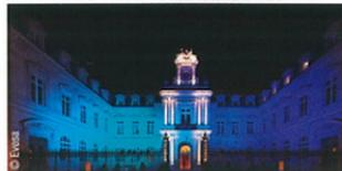
déplacés sur le trottoir d'en face (côté square du Temple). Ils supportent des projecteurs équipés de lampes aux iodures métalliques à brûleur céramique 70 W et 35 W et diffusent un éclairage général doux sur les parois verticales de la mairie qui sont parallèles à la chaussée. Les deux façades perpendiculaires à la rue Eugène-Spüller sont globalement moins éclairées de manière à créer un contraste et à conserver de nuit la perspective sur le bâtiment.
