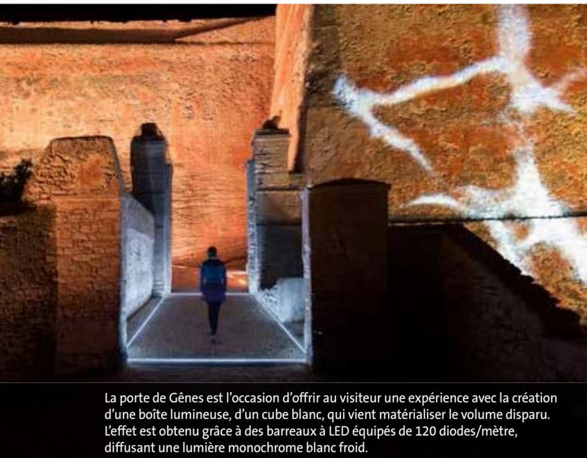
La porte de Gênes est l'occasion d'offrir au visiteur une expérience avec la création d'une boîte lumineuse, d'un cube blanc, qui vient matérialiser le volume disparu. L'effet est obtenu grâce à des barreaux à LED équipés de 120 diodes/mètre, diffusant une lumière monochrome blanc froid.
