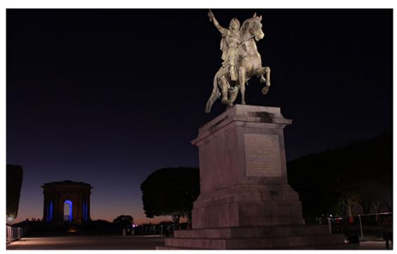
2 projecteurs LUMINY 4 (4039) installés sur les candélabres existants, assurent un éclairage puissant mais discret de la statue. Pour compléter le projet, 3 luminaires Corsica bleu (4660) permettent de mettre en valeur le château d'eau du fond.
